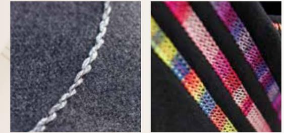
Einfach Messer wegklappen und im Material arbeiten für besondere Dekonähte.
